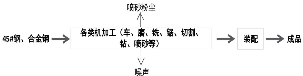
图 5-1 项目工装夹具工艺流程图
