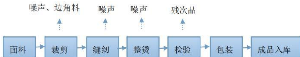
图 2-6 服装加工生产工艺及产污节点图
