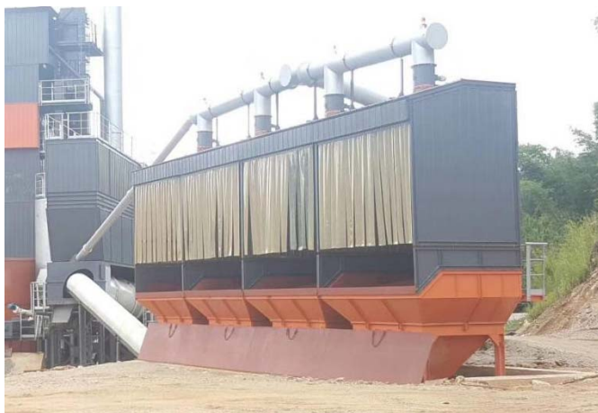
原生冷料仓、皮带输送等扬尘点防尘罩及除尘装置
